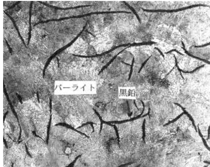
(b) 現代の鑄鉄 (片状黒鉛鑄鉄)
